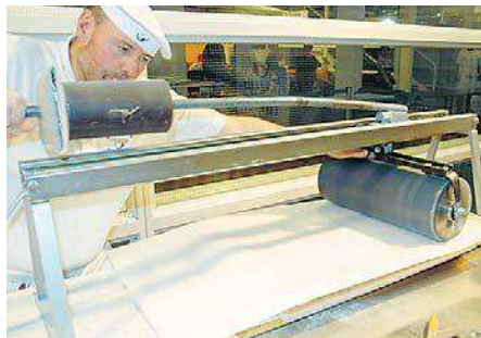
Tirggel-Herstellung: Die Kunstharzform wird gut eingölt, der 2-mm-Teig in die Form gepresst, von Hand nachgepresst und danach abgelöst und gebacken.
